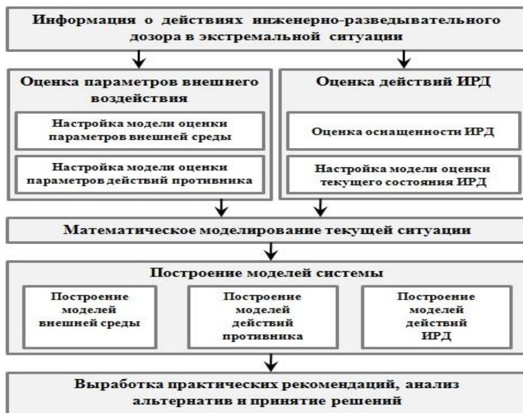
Рис.1. Структурная схема интегрированной среды моделирования действий ИРД в экстремальной ситуации
